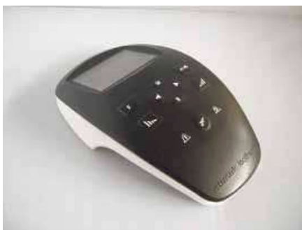
Bild 6: Erster Prototypendemonstrator mit der Polyform 3D Technologie
