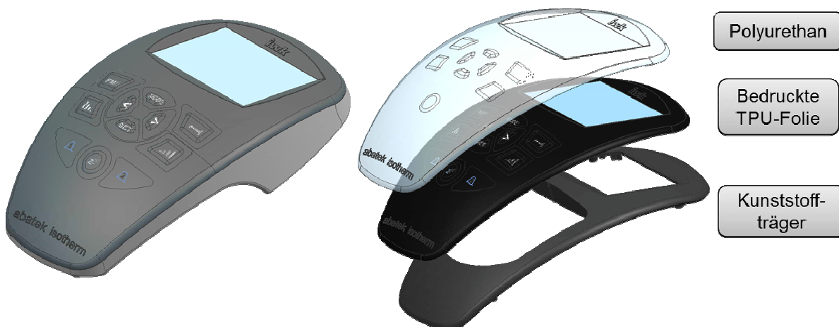
Bild 3: Demobauteil und Aufbau der einzelnen Komponenten
