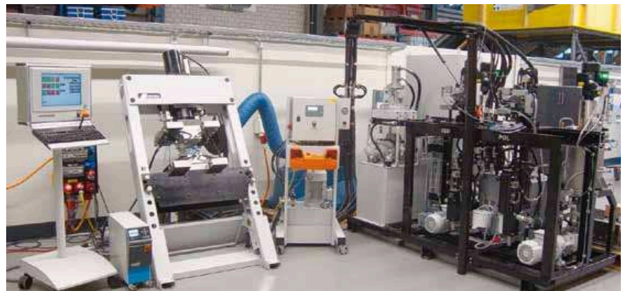
Bild 4: Werkzeugträger (links) und PUR-Anlage (rechts)
